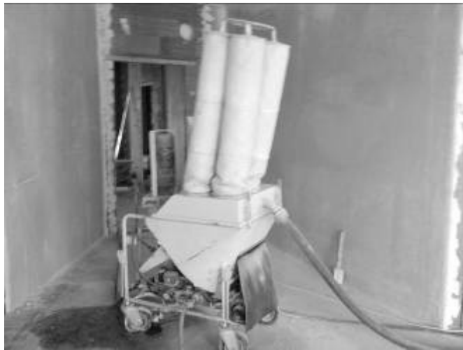
Фото 3. Штукатурна станція для приготування та нанесення розчинової суміші
