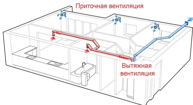
Рис. 1. Схема припливно-витяжної вентиляції
