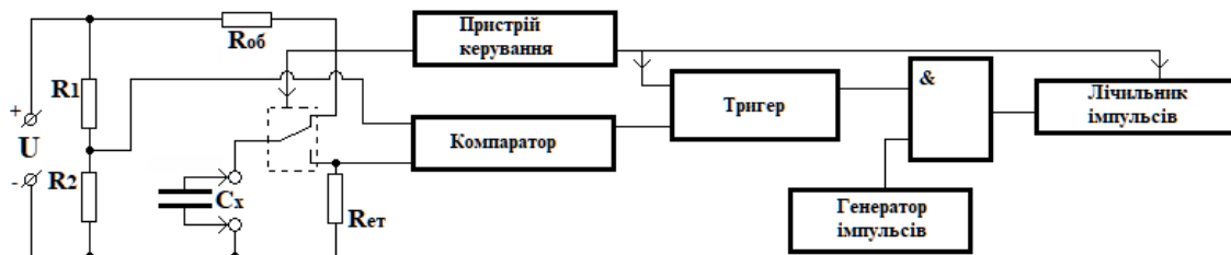
Рисунок 3 – Структурна схема пристрою для вимірювання ємності дискретним методом.
