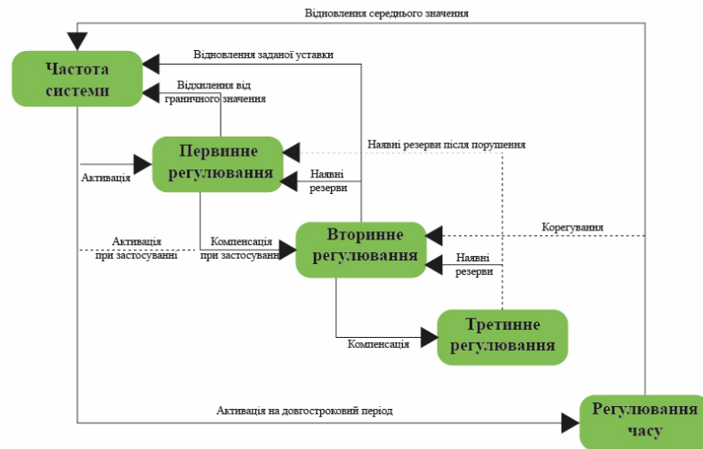
Рисунок 1 – Функціональна схема системи регулювання частоти та потужності в енергосистемі [4]
