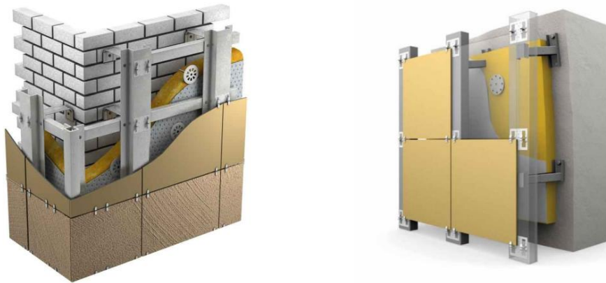
Рисунок 1 – Влаштування вентиляваного фасаду
