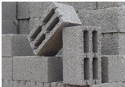
Рис. 5. Блоки із жаростійкого бетону
