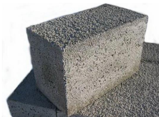
Рис. 6. Блоки із корозійностійкого бетону
