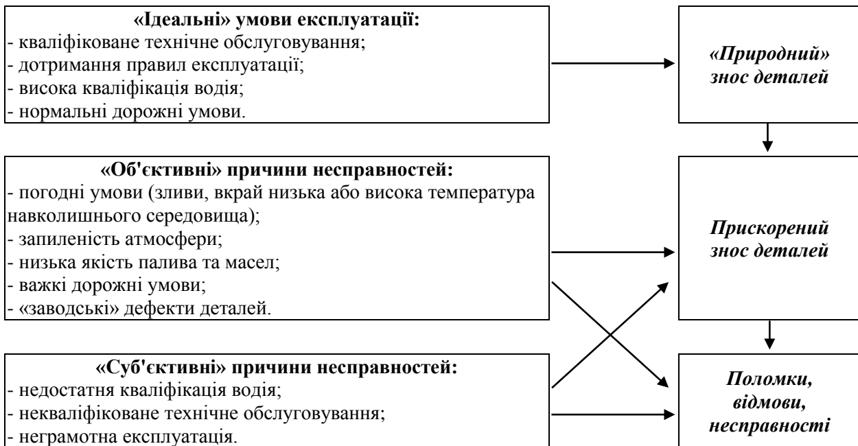
Рис. 1. Основні причини виникнення несправностей двигунів внутрішнього згорання
