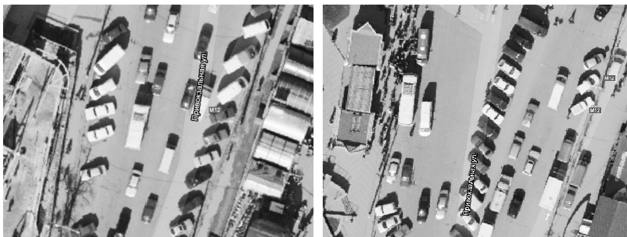
Рис. 1. Паркування машин на узбіччі доріг, що зменшує пропускну здатність на вул. Привокзальній
