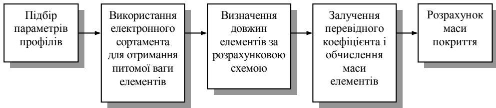
Рис. 4. Схема визначення маси покриття, підкріпленого горизонтальними фермами
