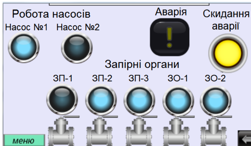
Рис. 2. Вікно швидкого циркуляційними насосами котельні
