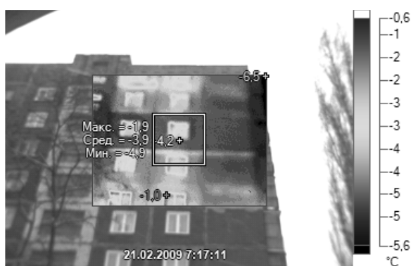
Рис. 6. Максимальна, середня й мінімальна температури виділеного фрагмента будинку
