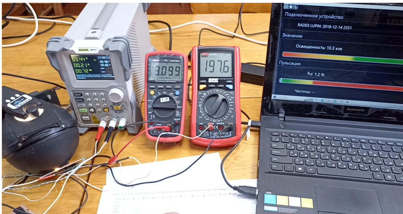
Рис. 1. Загальний вигляд лабораторного стенду для дослідження світлотехнічних характеристик та енергоефективності світлодіодів малої потужності.
