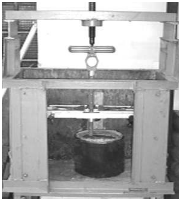
Рис. 3. Испытание модели сваи на стенде
