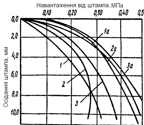
Рис. 2. Штампові дослідження намівних основ до і після ущільнення основ
