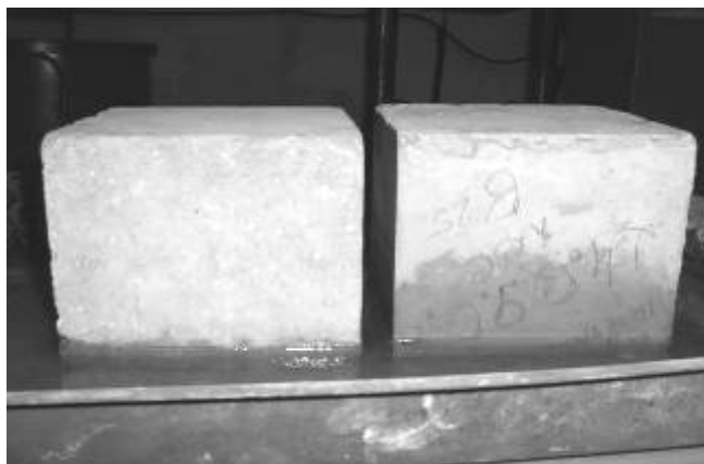
Рис. 1. Характер водяного підсмоктування води контрольним бетонним зразком і з добавкою 0,5 % пенетрону від маси цементу
