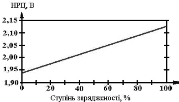
Рисунок 3.4 – Залежність напруги розімкнутого кола свинцево-кислотного акумулятора від рівня зарядженості [19]
