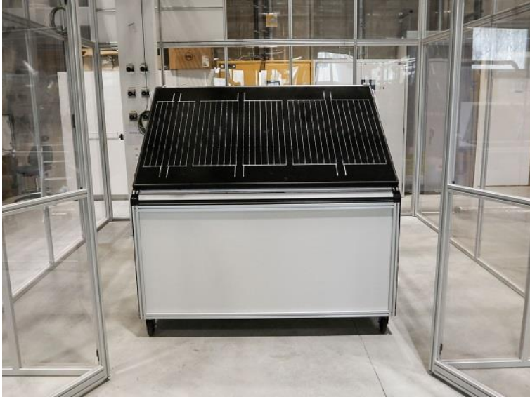
Рисунок 7.5 – Сонячна панель розщеплює воду для виробництва водню. Джерело: Solar Panel Splits Water to Produce Hydrogen, https://spectrum.ieee.org , Mar'19.
