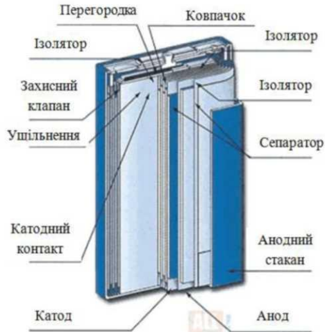
Рисунок 5.2 – Схема конструкції літійового акумулятора
