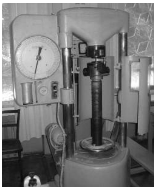
Рис. 3. Загальний вигляд машини КМ-50 з досліджуваним зразком
