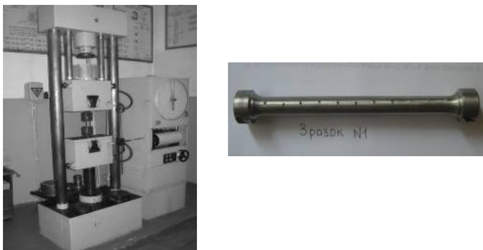
Рис. 2. Універсальна машина Р-20 з досліджуваним зразком
