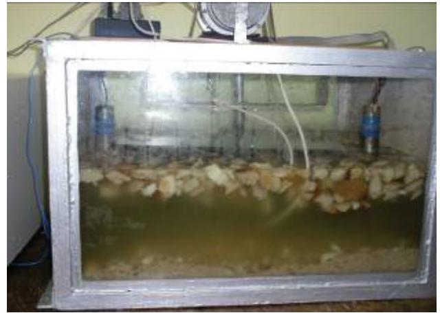
Рис 4. Вібраційна інтенсифікація теплообміну в реакторі
