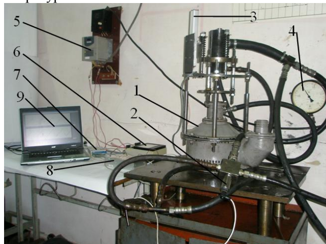
Рис. 2. Загальний вигляд експериментального стенда з вимірювальною апаратурою: 1 – НГПА, 2 – датчик тиску, 3 – датчик переміщення, 4 – мановакууметр, 5 – частотний перетворювач, 6 – ватметр, 7 – АЦП, 8 – блок живлення, 9 – ПЕОМ
