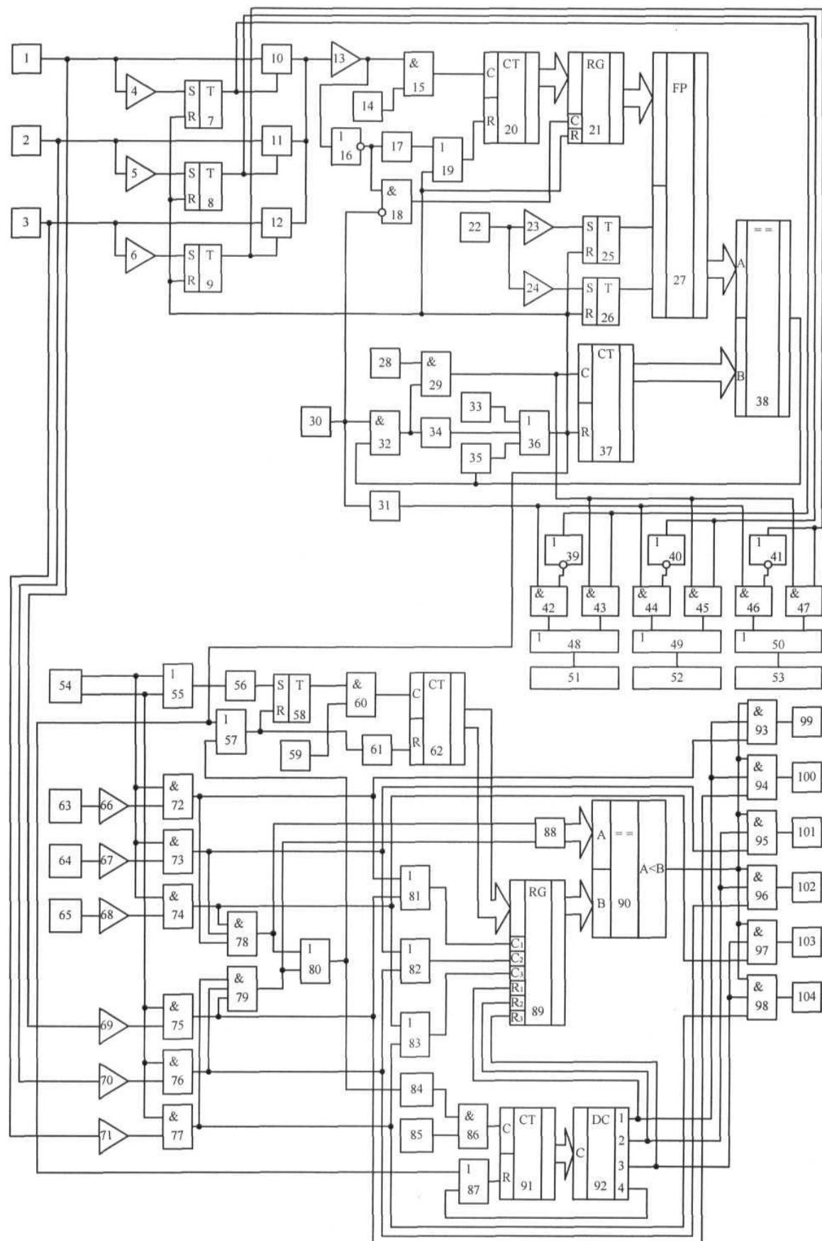
Корисна модель належить до електротехніки і може бути використана для вимірювання комутаційного ресурсу повітряних високовольтних вимикачів.
