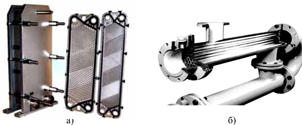
Рисунок 4.16 – Рекуперативні теплообмінники: пластинчастий (а) та кожухотрубчастий (б)
