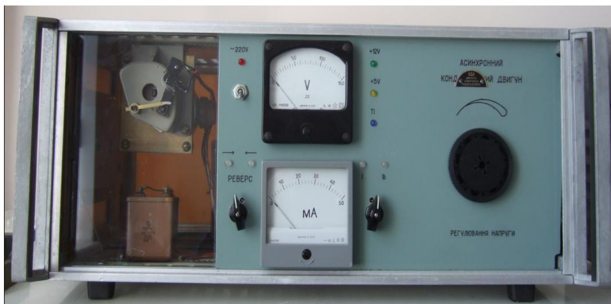
Рисунок 2.1 – Зовнішній вигляд лабораторної установки для дослідження асинхронного конденсаторного двигуна
