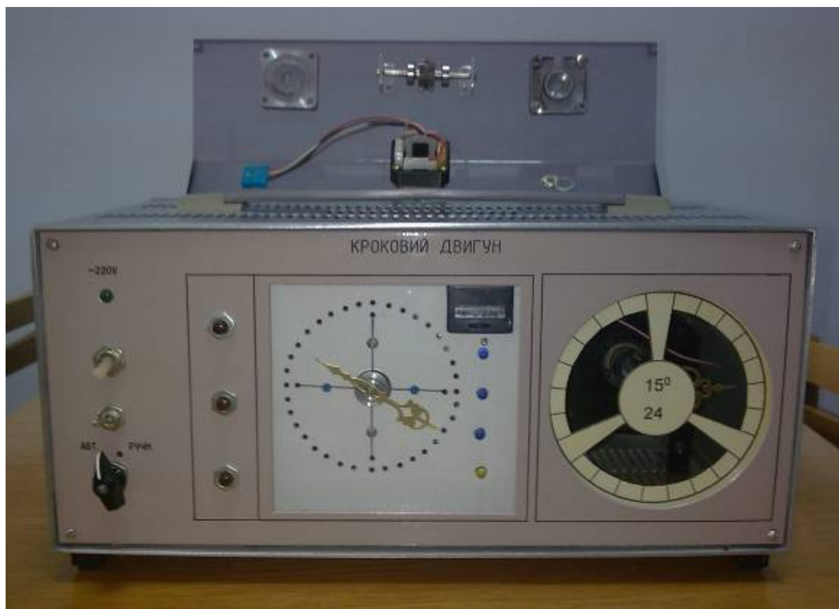
Рисунок 2.1 – Зовнішній вигляд лабораторної установки для керування кроковими двигунами
