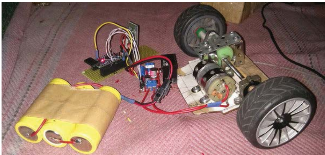
Рис. 3. Вигляд реалізованої електричної частини електромобіля
