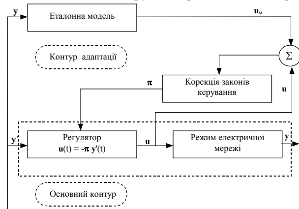
Рис. 2. Адаптивна система керування з еталонною моделлю
