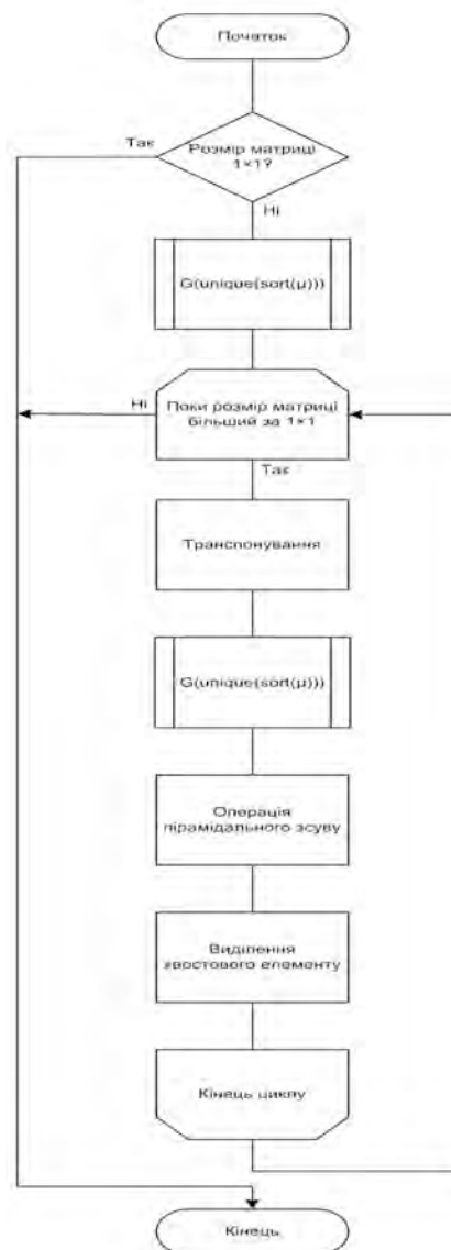
Рис. 1. Узагальнена схема алгоритму прямого паралельно-ієрархічного перетворення
