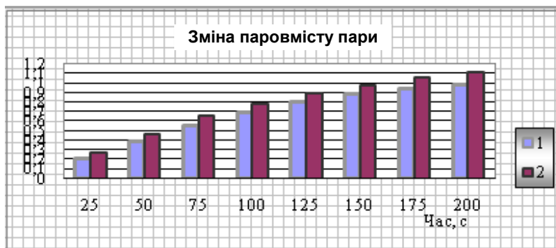
Рис. 4. Підтримка функціонування системи випарник—компресор на рівні прийняття рішень: 1 — гранично допустима працездатність випарника та ідентифікація прийняття рішення; 2 — діагностування збільшення витрати холодагента
