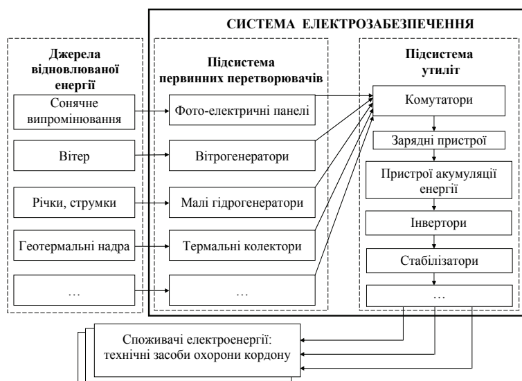
Рис. 1. Структурна схема локальної систем електрозабезпечення на основі відновлюваних джерел енергії
