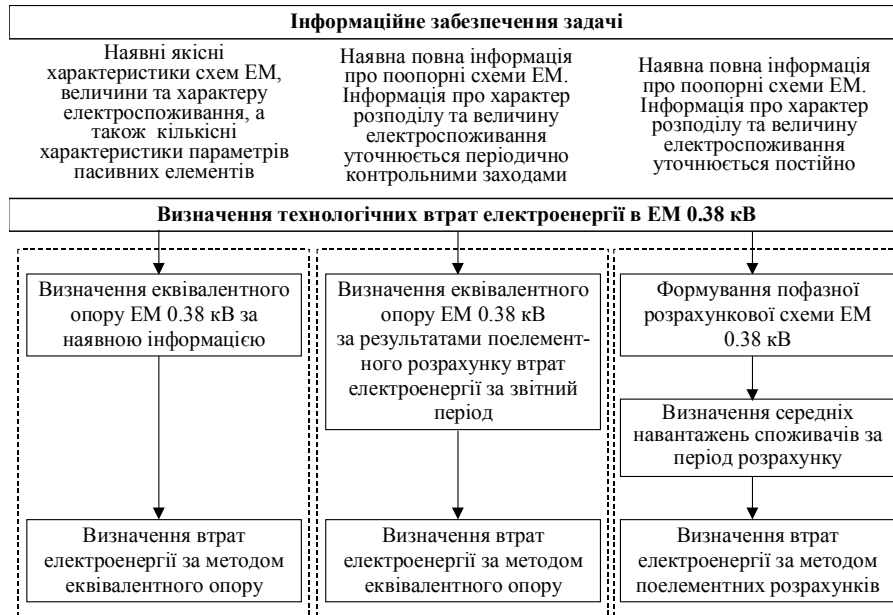
Рис. 1. Структура методів та послідовність визначення технологічних втрат електроенергії в ЕМ 0,38 кВ за різного інформаційного забезпечення
