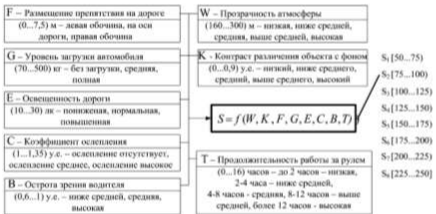
Рисунок 1 – Структура модели определения дальности видимости S (указаны: факторы влияния, универсальное множество и термы для их оценки)
