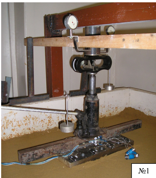
Рис.2 – Моделі фундаменту мілко закладання під навантаженням
