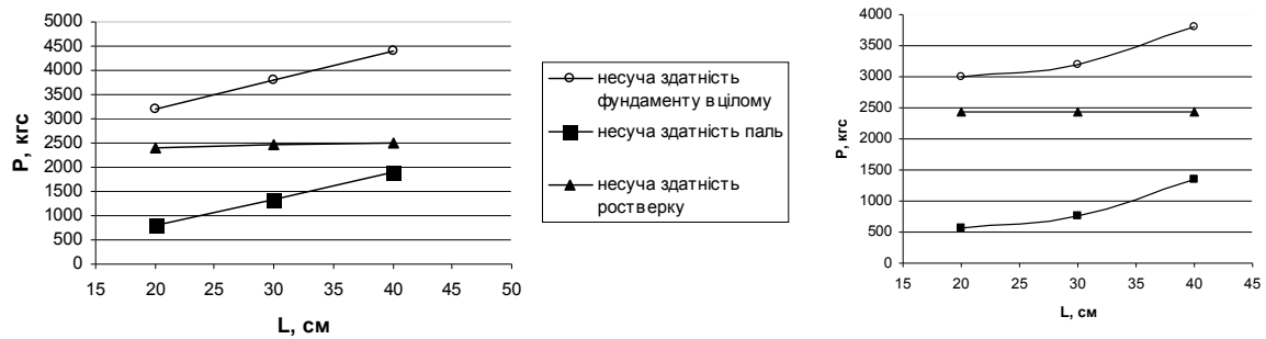
Рис.4 – Графік залежності несучої здатності фундаменту від довжини паль при кроці паль 3d (зліва) і 6d (справа)
