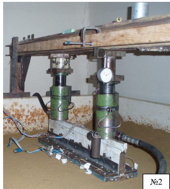
Рис.2 – Моделі фундаменту мілко закладання під навантаженням
