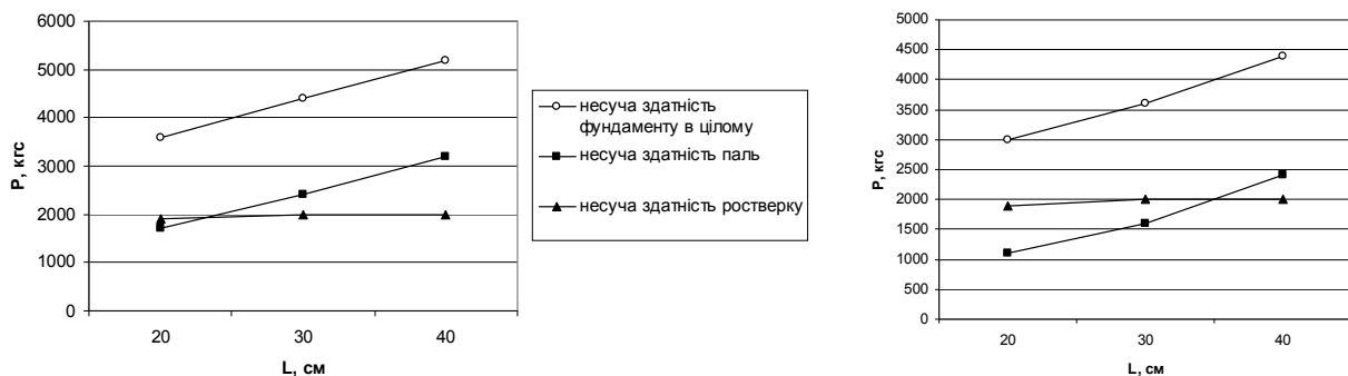
Рис.9 – Графік залежності несучої здатності фундаменту від довжини паль при кроці паль 3d (зліва) і 6d (справа)
