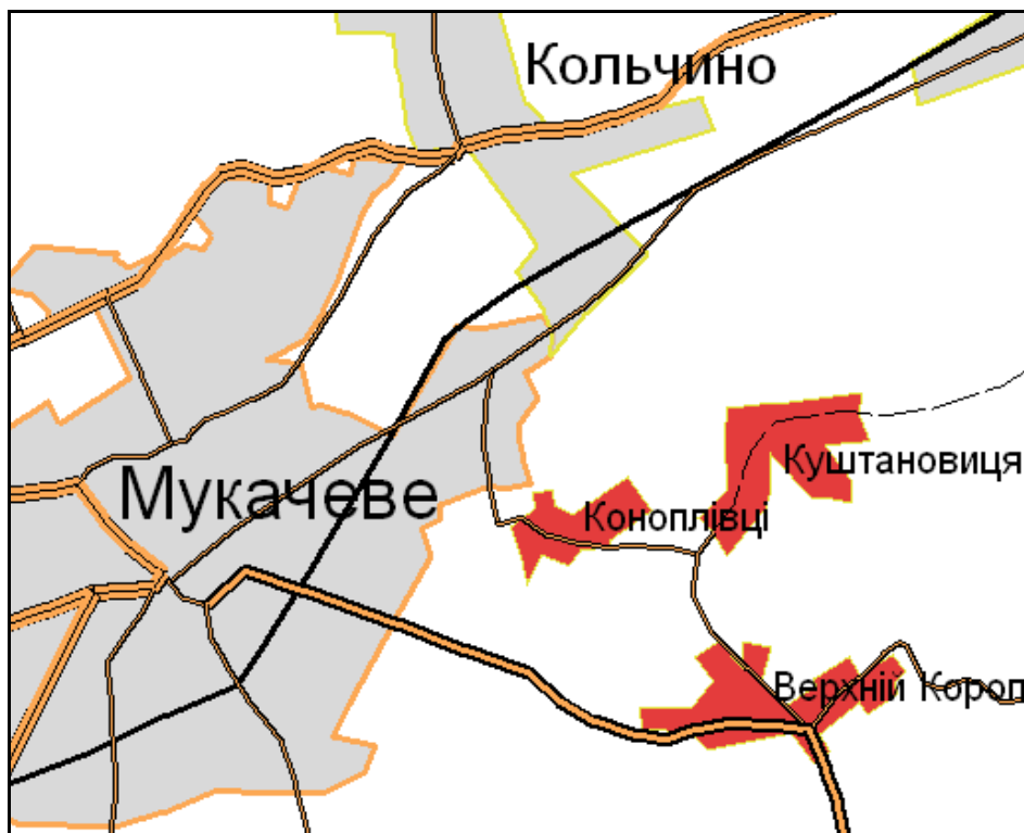
Рисунок 3.11 — Збільшений фрагмент векторної карти «Дорожня мережа», виведеної спільно з картою «Міста» та з картою «ССТ», де добре видно використані умовні позначення для відображення таких доріг, як «Відомчі дороги» (подвійні лінії), «Залізниці ширококоліїні» (суцільно чорні лінії), «Польові дороги» (пунктирні лінії) «Удосконалене шосе» (одинарні товсті лінії) та «Шосе» (тонкі лінії)
