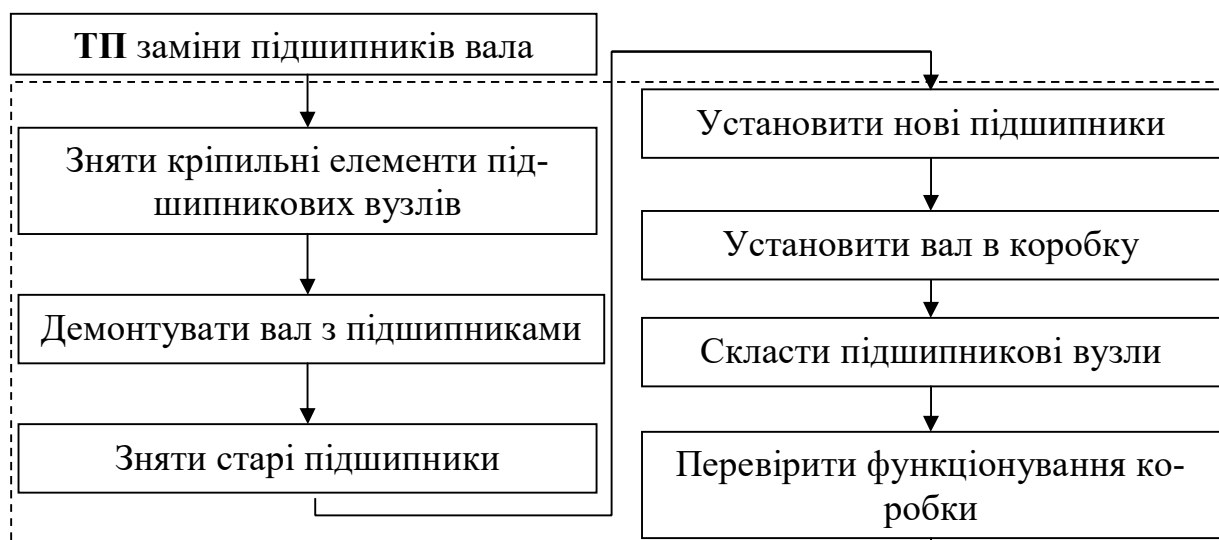
Рисунок 4.3 – Блок-схема послідовності T\Pi заміни підшипників на валу коробки швидкостей верстата
