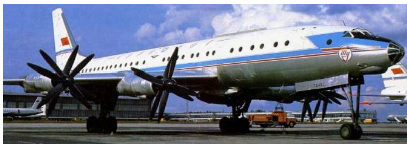
Рисунок 17.3 – Радянський літак Ту-114: пасажиромісність – 170 – 220; довжина – 54,1 м; розмах крила - 51,1 м; висота – 15,5 м; потужність двигунів – 4 \times 15000 ; макс. швидкість – 880 км/год; дальність польоту – 9720 км
