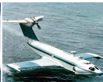
Рисунок 17.5 – Швидкісні судна: а – на підводних крилах; б – на повітряній подушці ; в – екраноплан
