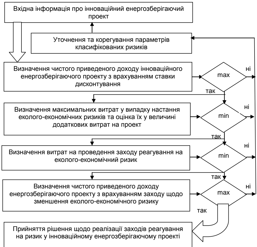
Рис. 1 Структурно-логічна модель оцінки ефективності заходів реагування на ризик енергозберігаючого проекту.
