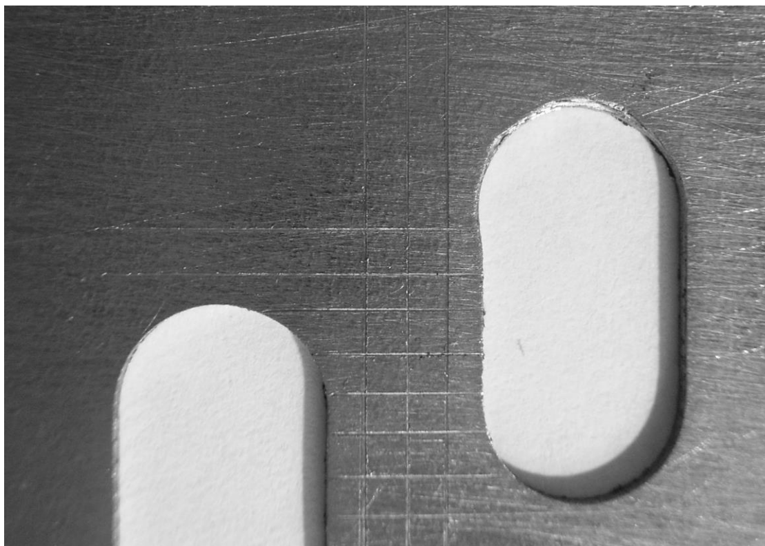
Рис. 3.6. Фотографія зони зсуву зразка до руйнування
