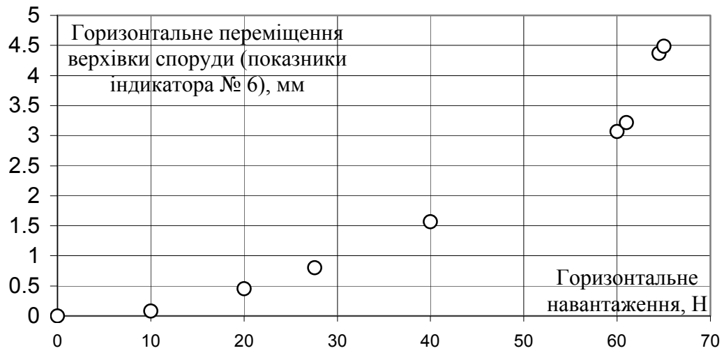
Рис. М.3. Залежність загальних горизонтальних деформацій верхівки споруди від прикладеного горизонтального навантаження
