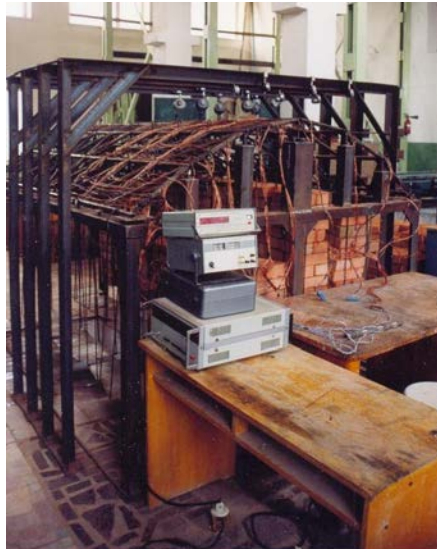
Рис. 3. Модель з приладами для вимірювання відносних деформацій
