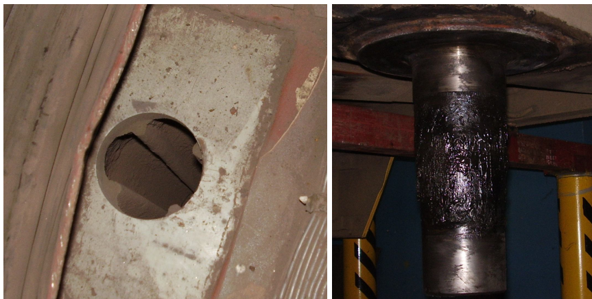
Рис. 1 – Шкворінь трамваю: а - вигляд з салону, б – вигляд знизу.
