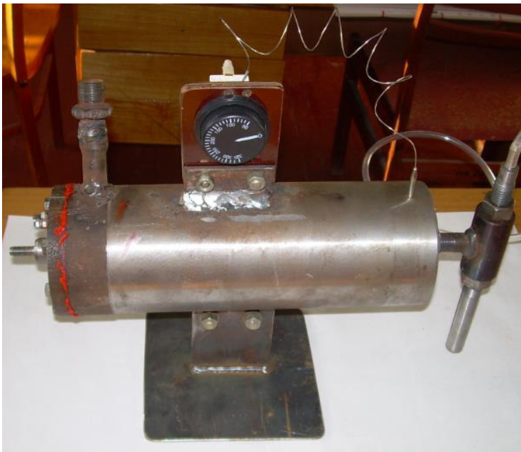
Рисунок 1 - Установка для газодинамічного нанесення функціональних покриттів. 1 – нагрівач повітря. 2 – розпилювач порошку
