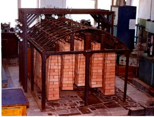
Рис. 6. Повне прикладання навантаження до моделі покриття з горизонтальними фермами
