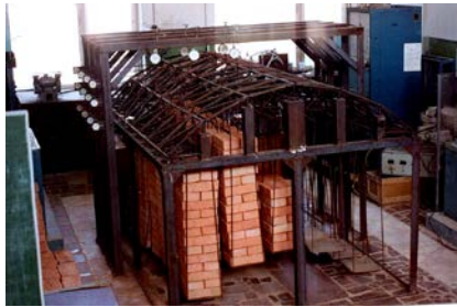
Рис. 6. Повне прикладання навантаження до моделі покриття з горизонтальними фермами
