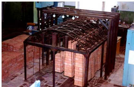
Рис. 7. Однобічне прикладання навантаження до моделі покриття з горизонтальними фермами: а) зліва; б) справа
