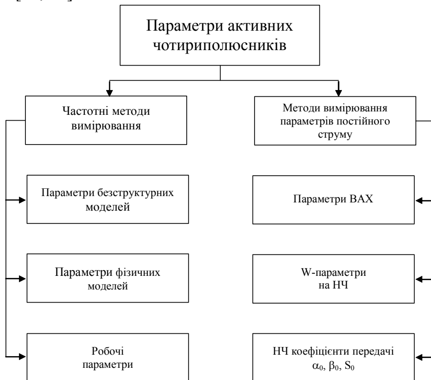
Рис. 1.11. Узагальнена класифікація методів вимірювання і параметрів активних чотириполіусників
