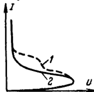
Рис. 2.21. Вольт-амперна характеристика динистора: 1 – за наявності генерації на ділянці ВО; 2 – генерація відсутня
