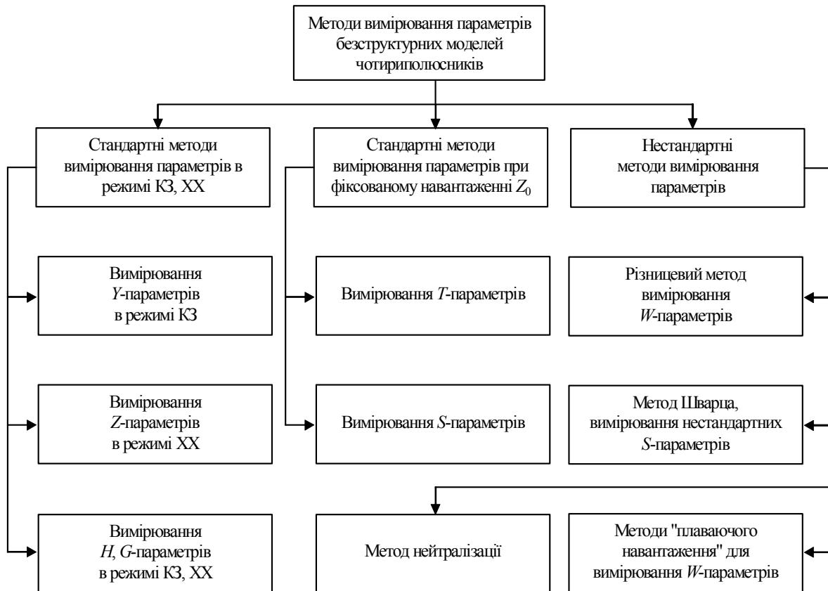
Рис. 3.1. Класифікація методів вимірювання параметрів безструктурних моделей чотириполосників
