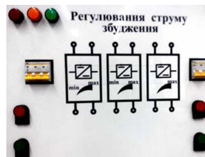
Рис. 1. Блок для регулювання струму збудження
