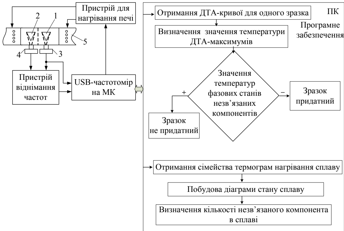
Рис. 2. Структурна схема методу неруйнівного контролю структурних перетворень некристалічних напівпровідників
