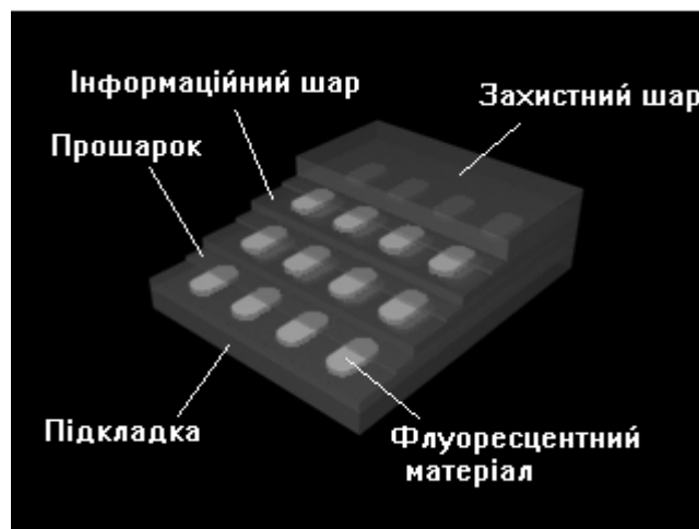
Рисунок 14 – Конструкція FMD диску
