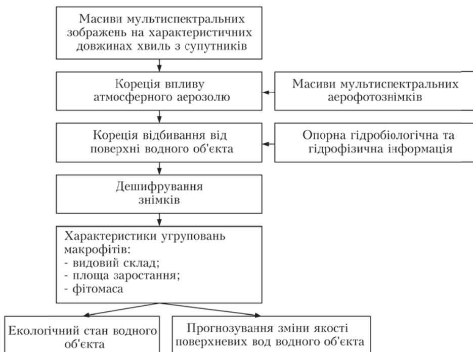
Рис. 2. Структурна схема тривірневого оптичного контролю екологічного стану водних об'єктів за характеристиками макрофітів
