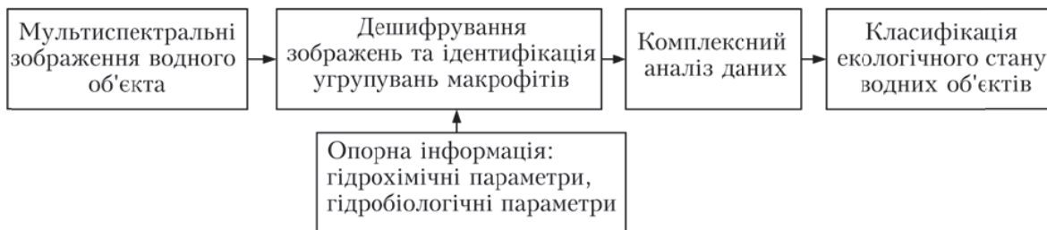
Рис. 1. Структурна схема обробки результатів дистанційного оптичного контролю водних об'єктів
