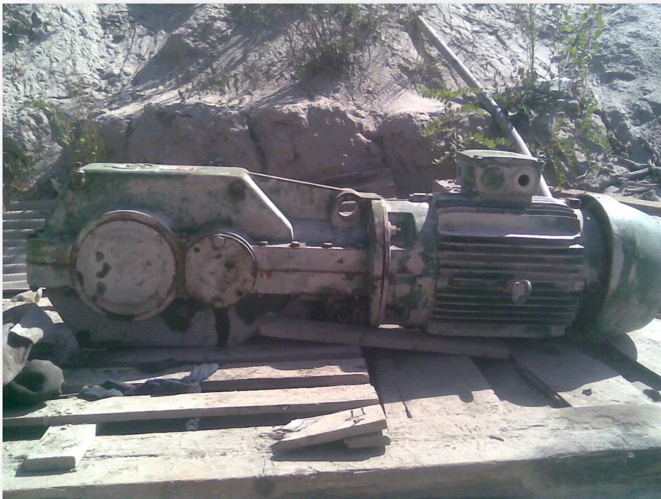
Світлина конічно-циліндричного двоступінчастого мотор-редуктора, що використовується як привод барабана конвеєра на ПрАТ «Стрижавський кар'єр»
