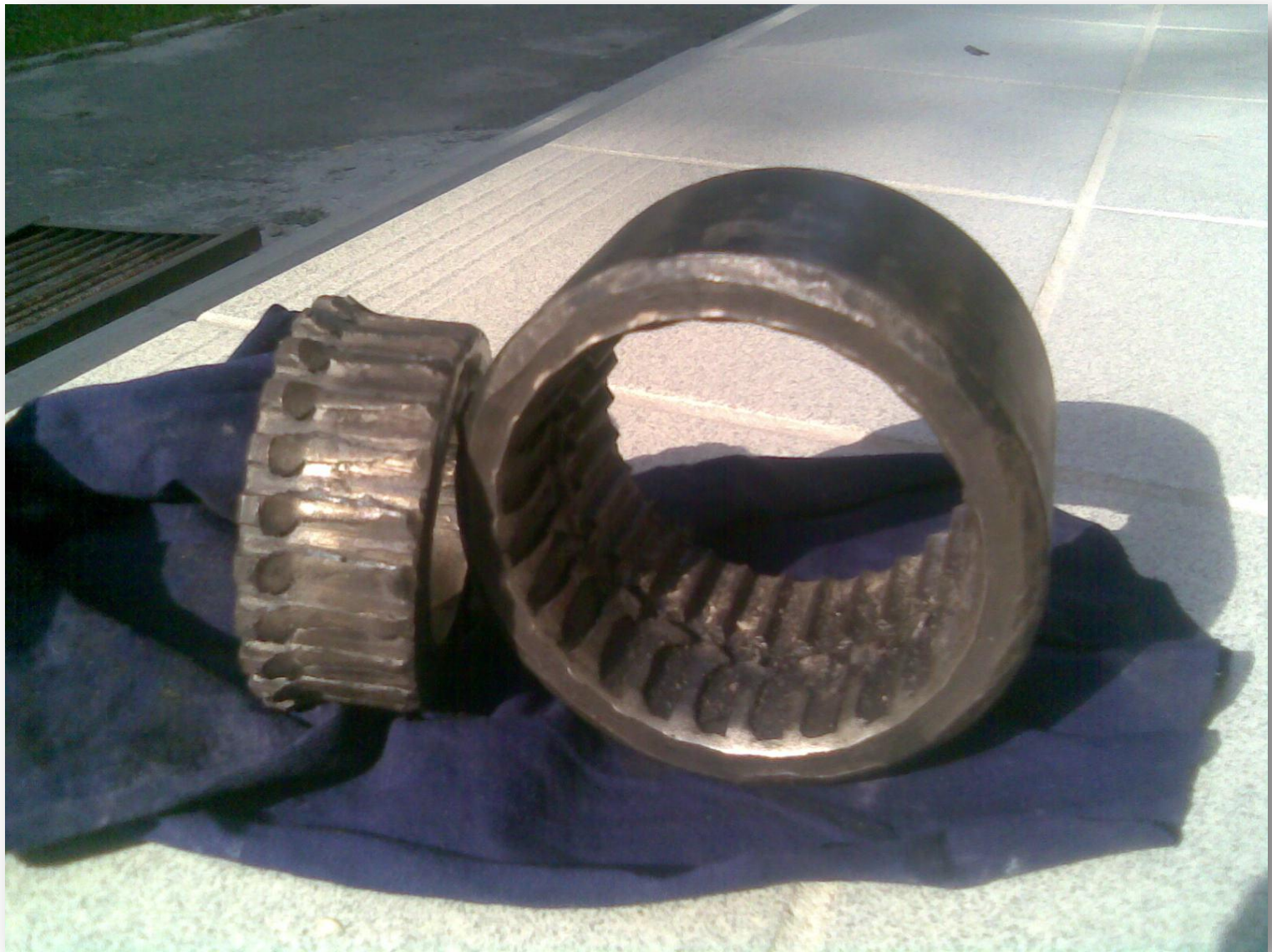
Елементи конічної передачі мотор-редуктора, які вийшли з ладу після 3-х років експлуатації
