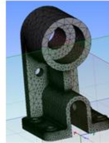
Крок 2. Сітка деталі, побудована методом кінцевих елементів
