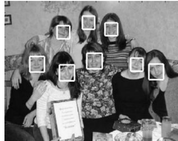
Рисунок 12.1 – Виявлення облич на тестовому зображенні: а) тестове зображення; б) виявлення облич після застосування алгоритму на базі навчальної мережі SNoW.
