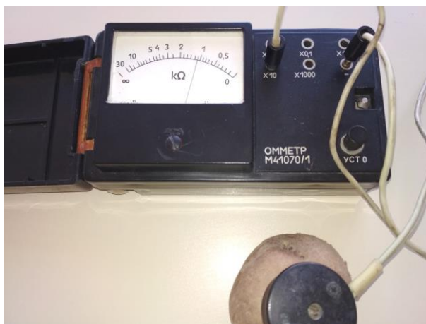
Рисунок 2 – Установка для першого завдання
