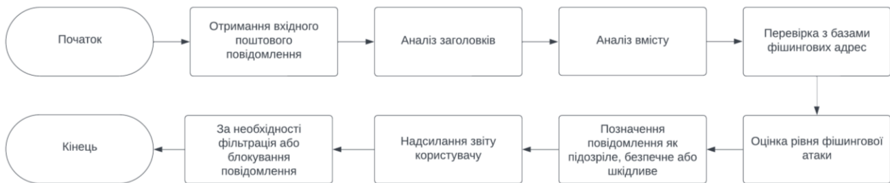
Рисунок 1 – Схема роботи програмного засобу для перевірки електронних листів
